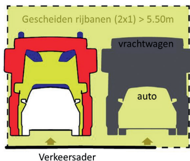
Figuur 7.7: Minimale verharde breedte van een verkeersader met eenrichtingsverkeer
